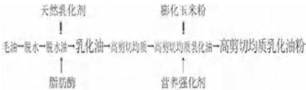
图 1 乳化酶解油粉的制作工艺
